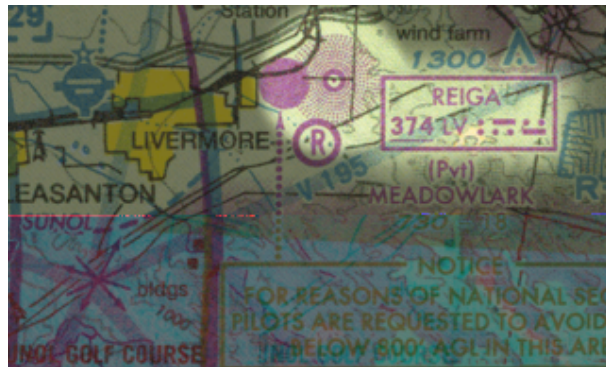
图 10.12: REIGA 无方向性信标台
