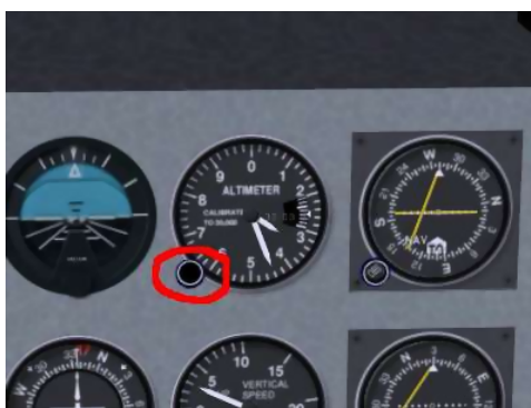
图 9.7: 高度表拨正值调节旋钮
